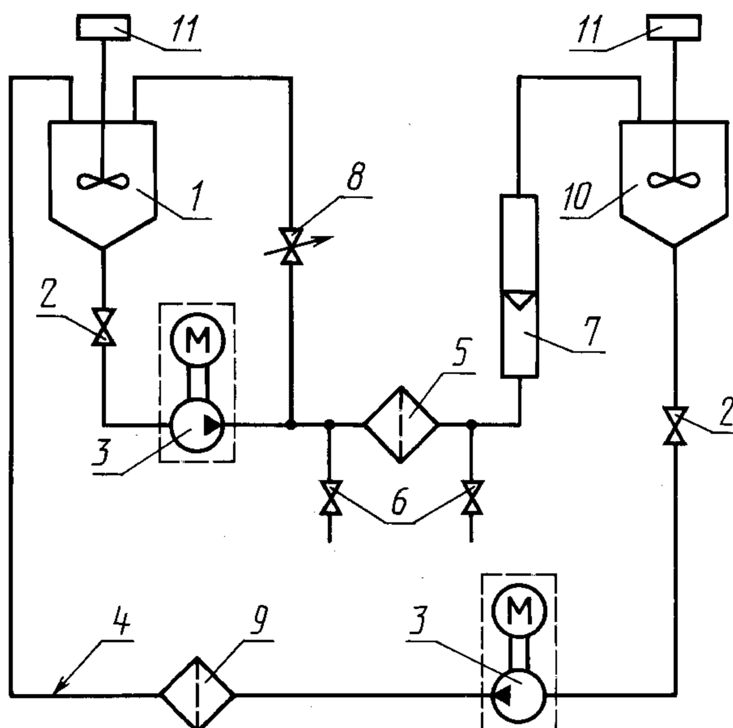
1 — расходный бак; 2, 8 — краны; 3 — насос; 4 — соединительные трубы и шланги; 5 — испытуемый фильтр;
