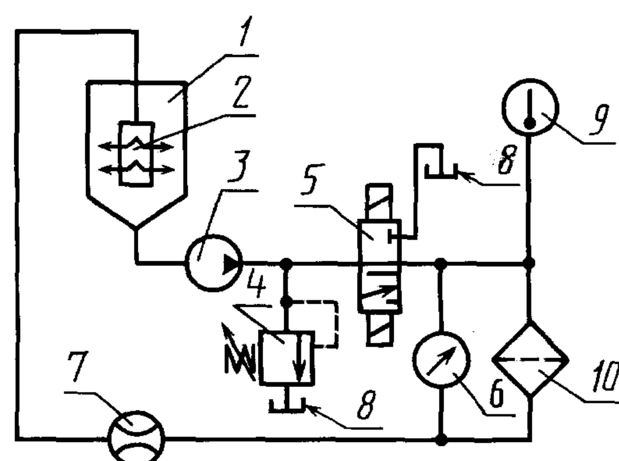
1 — бак; 2 — диффузор; 3 — насос; 4 — предохранительный клапан; 5 — распределитель гидравлический; 6 — дифманометр; 7 — расходомер; 8 — бак; 9 — термометр; 10 — испытуемый фильтроэлемент
