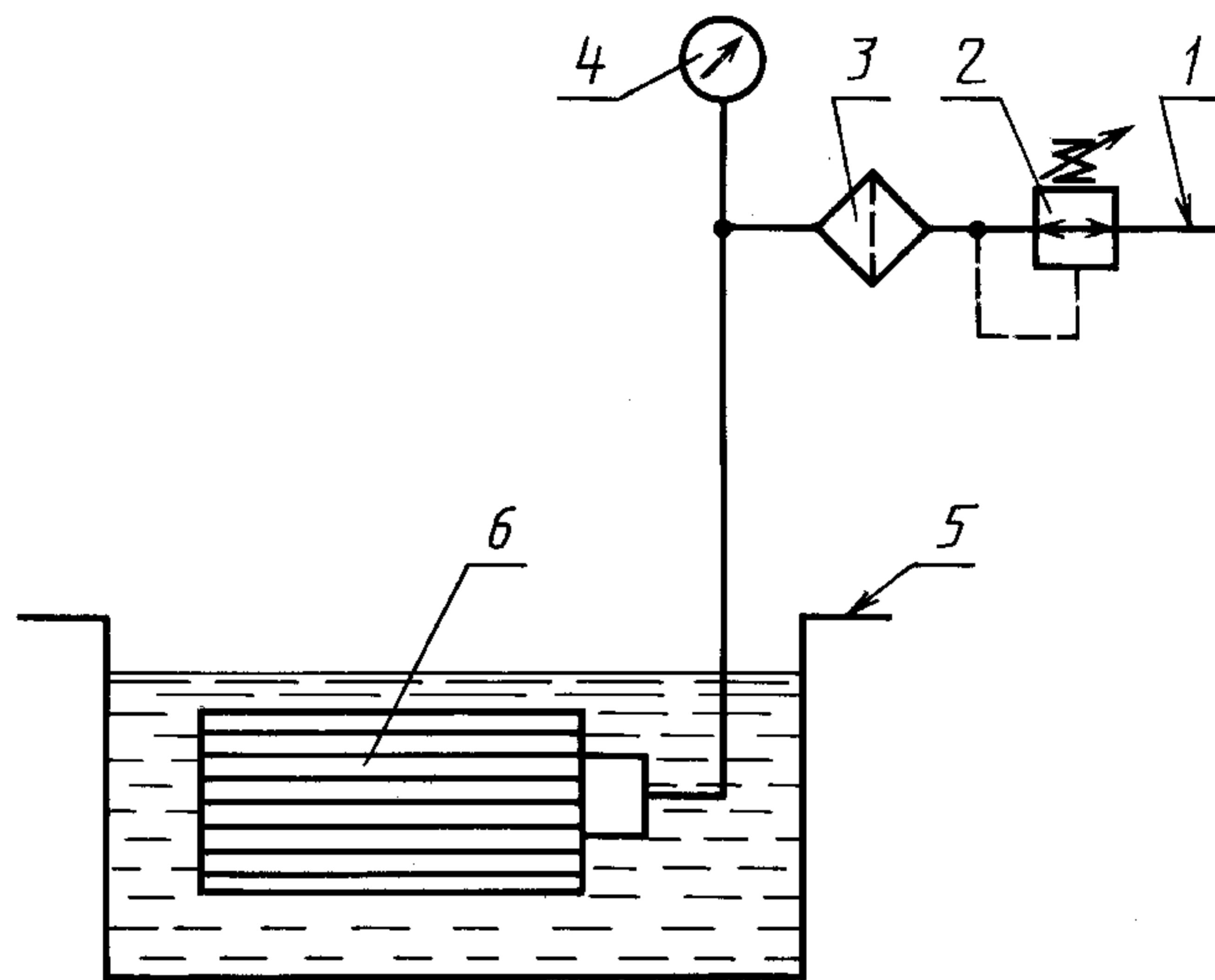
1 — подвод воздуха; 2 — редукционный пневмокран; 3 — воздушный фильтр; 4 — манометр; 5 — ванна для жидкости; 6 — испытуемый фильтроэлемент
