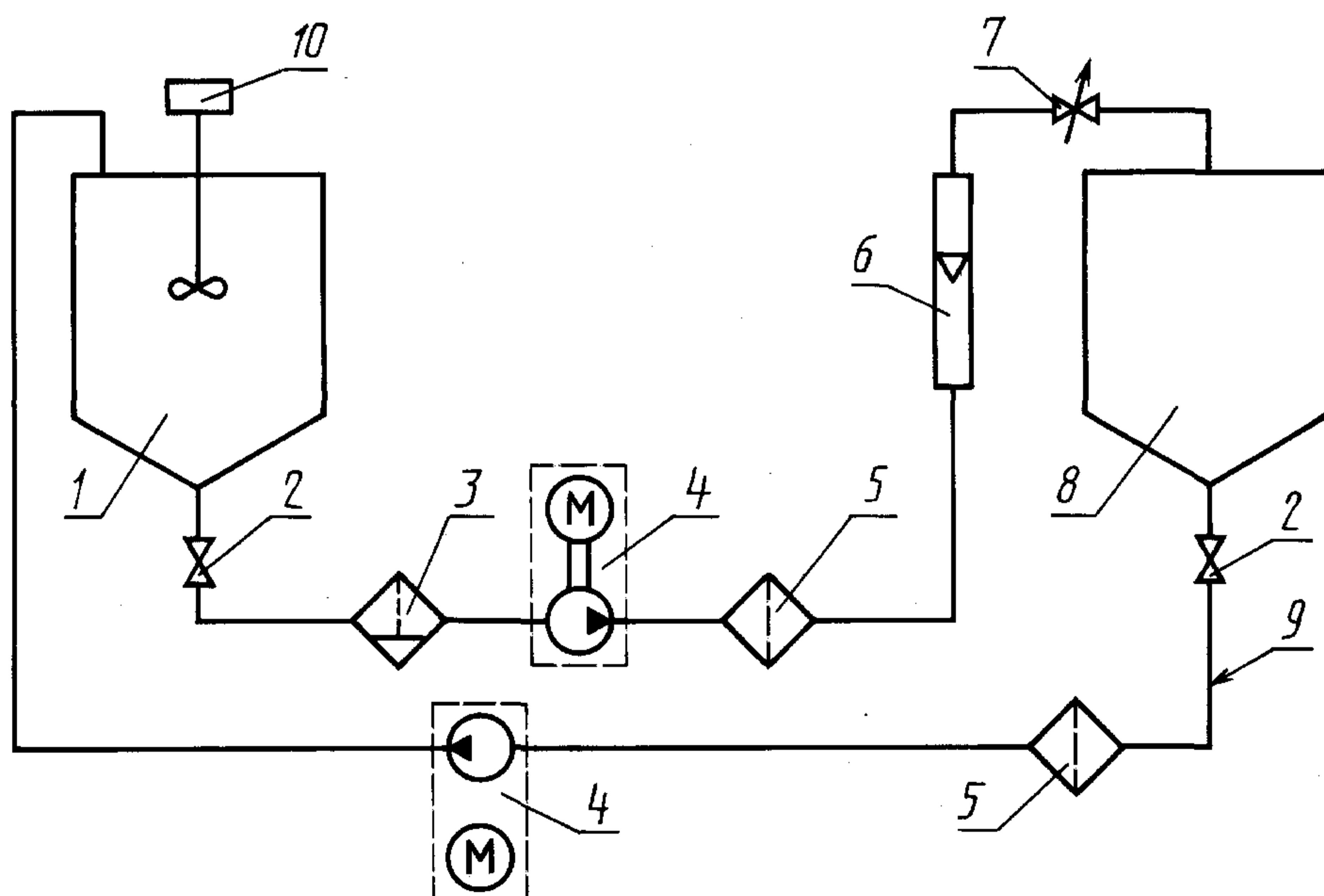
1 — расходный бак; 2, 7 — краны; 3 — испытуемый фильтр; 4 — насос; 5 — технологический фильтр; 6 — ротаметр; 8 — вспомогательный бак; 9 — соединительные трубы;
