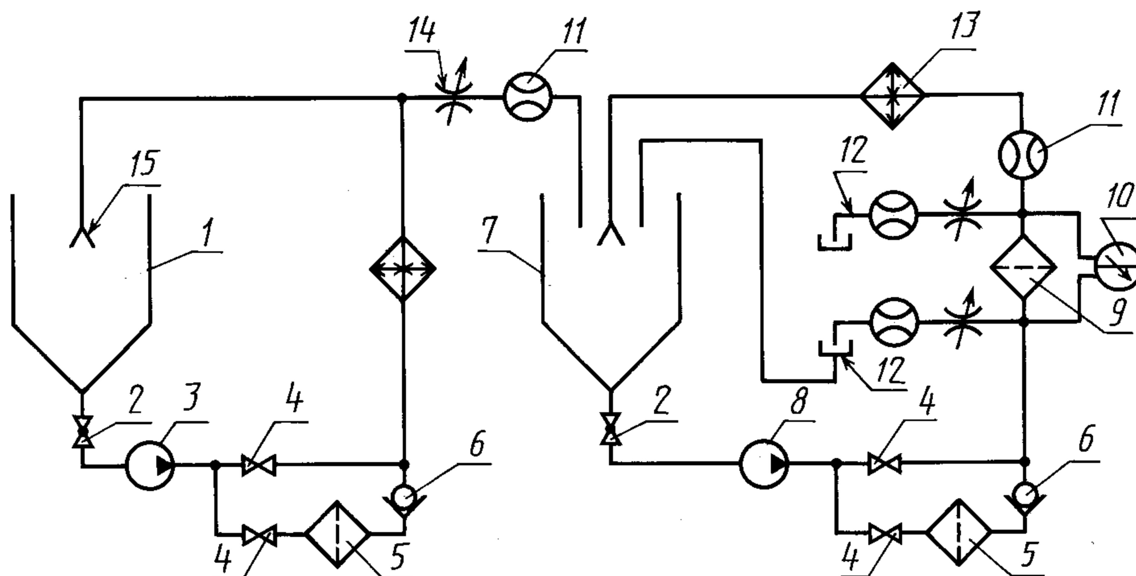
1 — гидробак системы введения загрязнителя; 2 — кран; 3 — насос системы введения загрязнителя; 4 — вентиль; 5 — фильтр технологический; 6 — обратный клапан; 7 — гидробак системы испытания фильтра; 8 — насос системы испытания фильтра; 9 — фильтр испытуемый; 10 — манометр дифференциальный; 11 — расходомер; 12 — устройство для отбора проб; 13 — теплообменный аппарат; 14 — дроссель; 15 — диффузор
