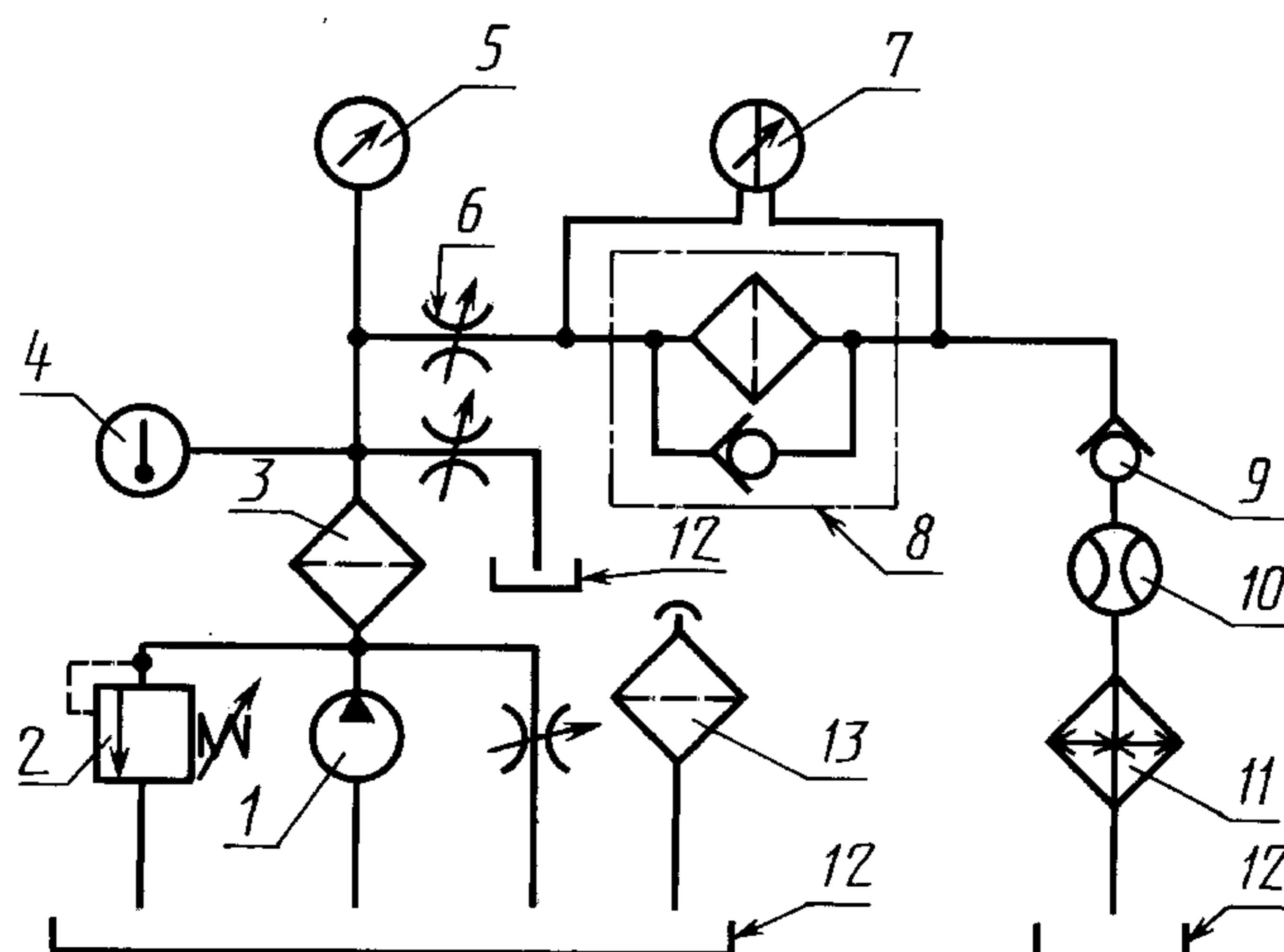
1 — насос; 2 — предохранительный гидроклапан; 3 — технологический фильтр; 4 — термометр; 5 — манометр; 6 — дроссель; 7 — манометр дифференциальный; 8 — фильтр испытуемый; 9 — обратный клапан; 10 — расходомер; 11 — теплообменный аппарат; 12 — гидробак; 13 — сапун
