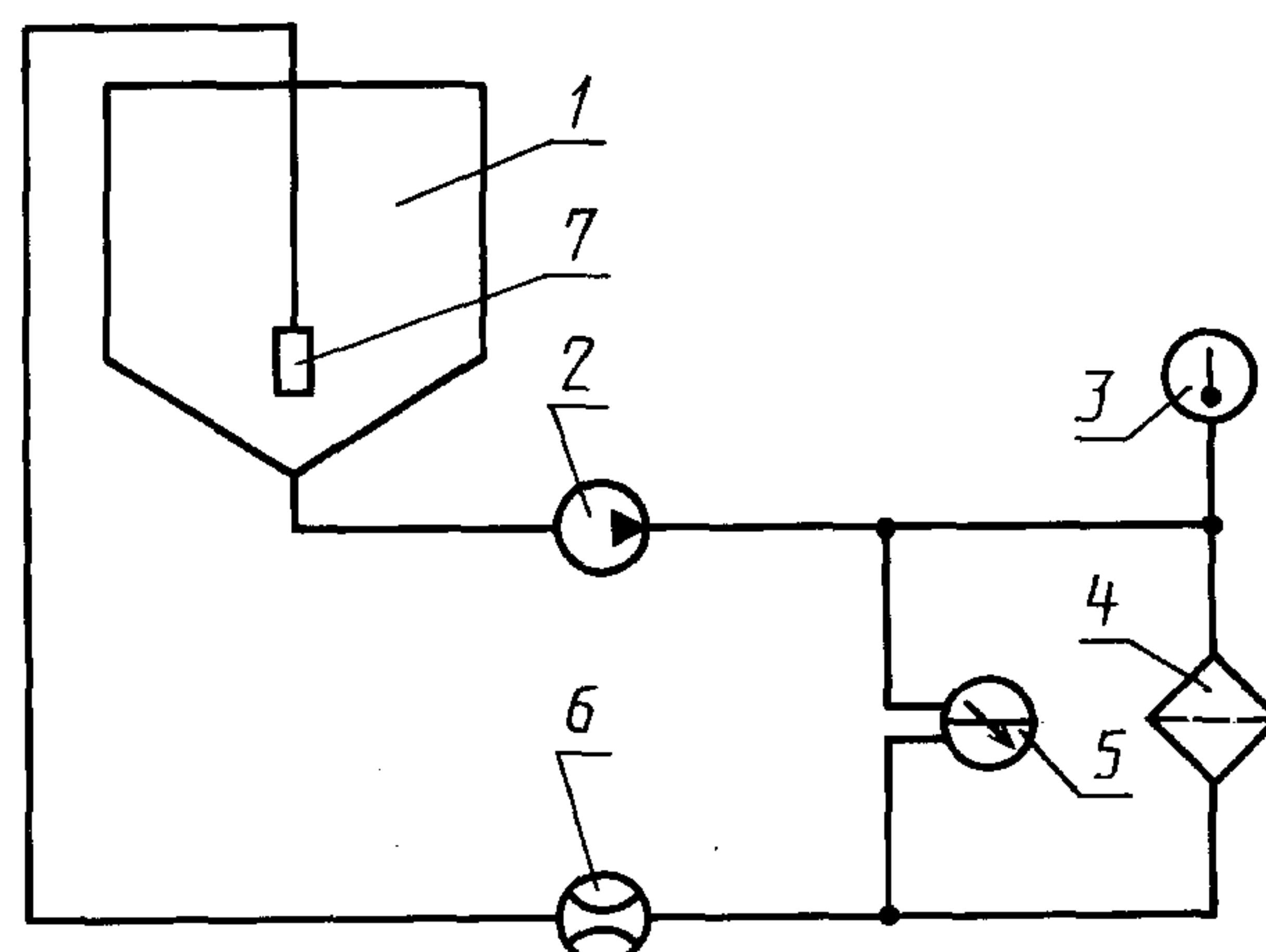
1 — бак; 2 — насос; 3 — термометр; 4 — корпус с испытываемым фильтроэлементом; 5 — дифференциальный манометр; 6 — расходомер; 7 — диффузор
