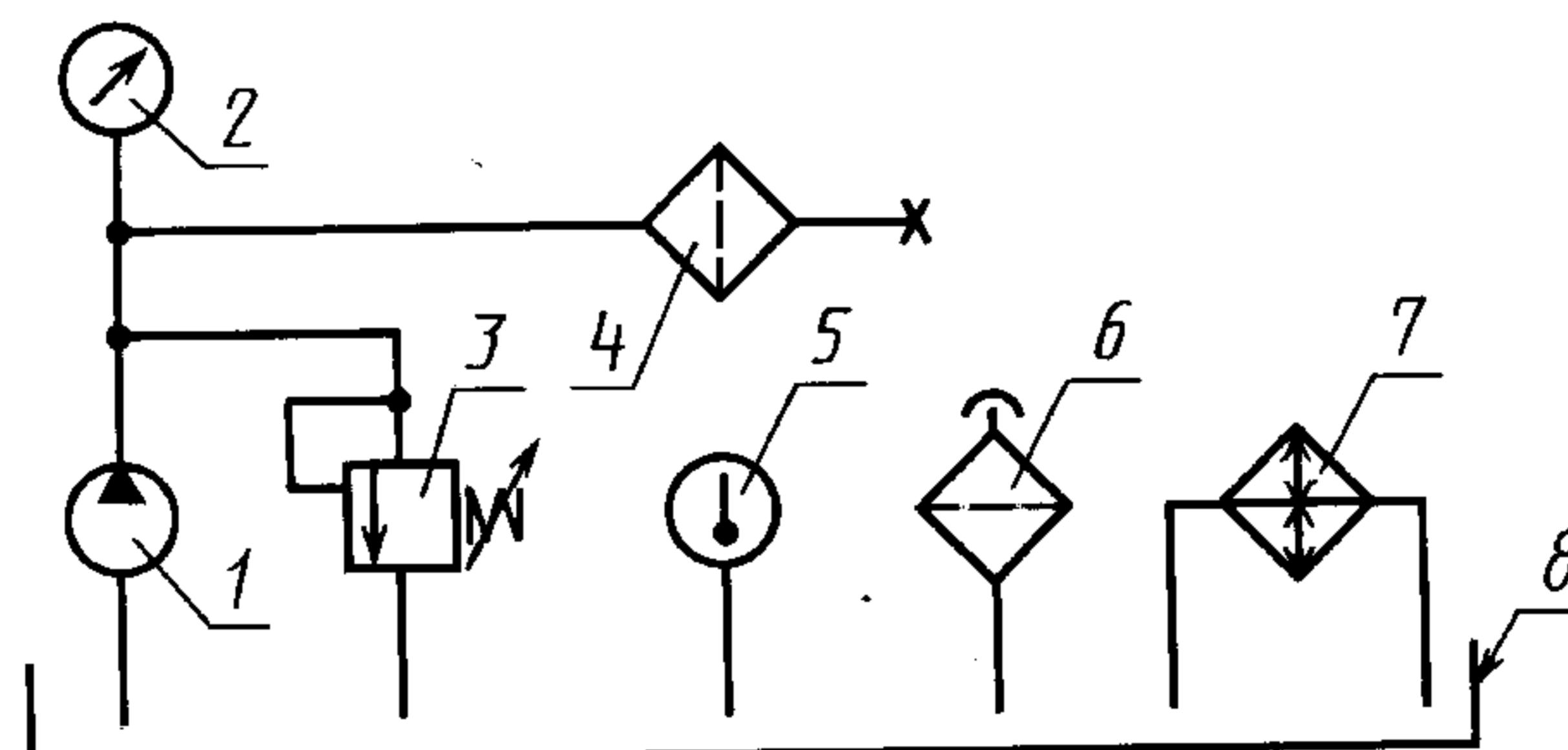
1 — насос; 2 — манометр; 3 — предохранительный клапан; 4 — испытуемый фильтр; 5 — термометр; 6 — сапун; 7 — теплообменный аппарат; 8 — бак
