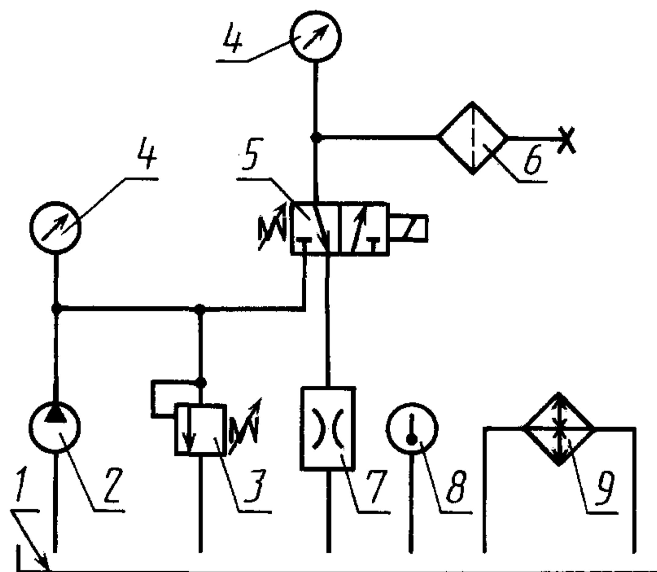
1 — бак с рабочей средой; 2 — насос; 3 — предохранительный клапан; 4 — манометр; 5 — распределитель рабочей среды; 6 — испытуемый фильтр; 7 — дроссель; 8 — термометр; 9 — теплообменный аппарат
